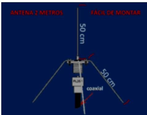
3º Cinco varilla de cobre, acero o alambre galvanizado y su grueso es de 2'05 mm, el largo del vertical y de los planos de tierra es de 50 cm uno va soldado en el centro como se ve en la figura, pueden dejarlos un poco más largo para cuando se regulen las estacionarias (swr) ya que se suele ir cortando a todas las varillas a la misma medida, pero la ideal es de 50 cm. Los planos de tierra llevan una inclinación de 45º.
